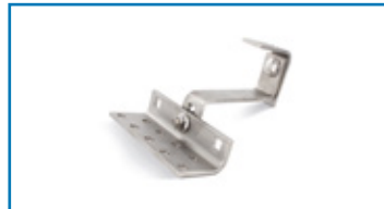
Vario-Solarhaken, 3-fach verstellbar, Stiel 5 mm, 140X56X5/5
